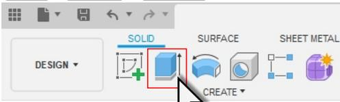
14 Повернуть деталь, выдвинуть созданный контур на 15 мм, вырезать объем.
