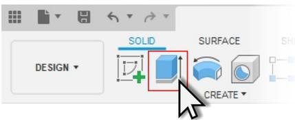
**8** Выдавить созданный контур на 1,5мм
